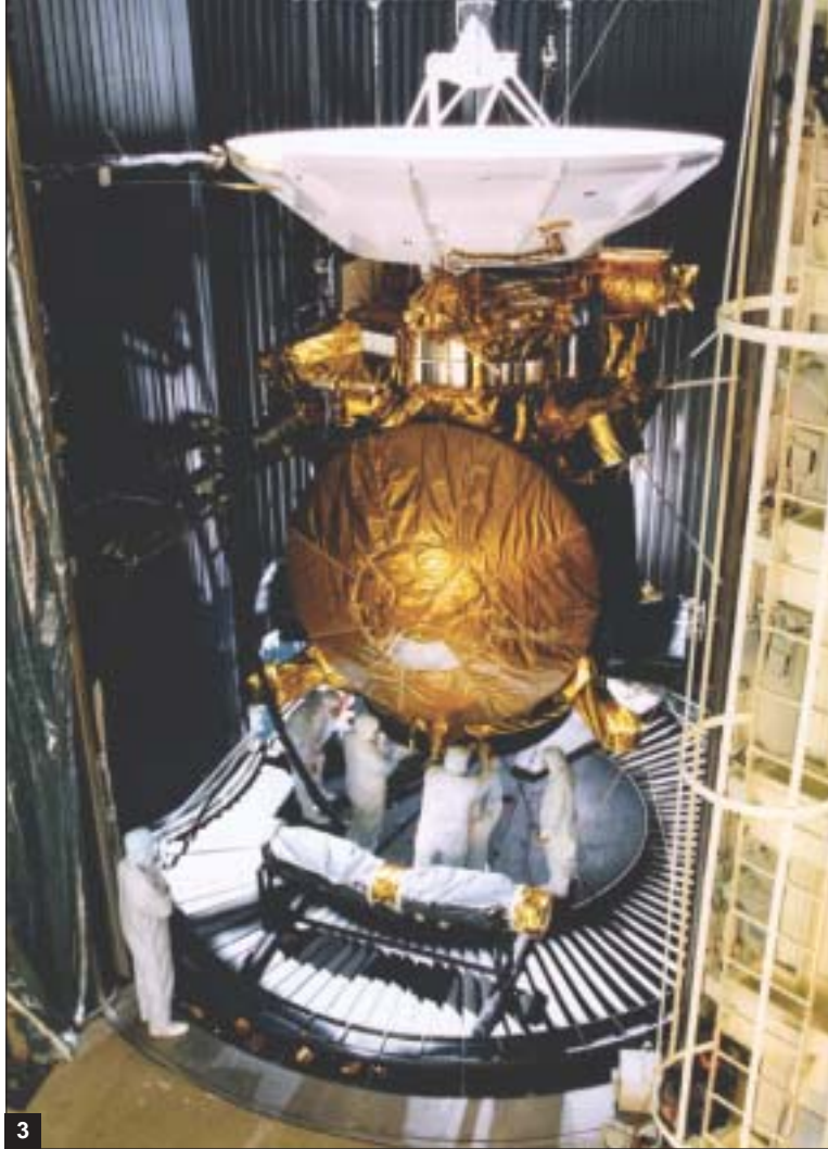
3 – Cassini sur son banc de montage. Le disque doré au milieu de la sonde est le module européen Huygens
